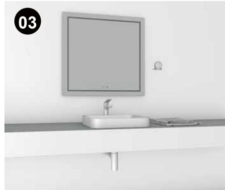
Coloque el espejo en la posición deseada, identifique y marque los puntos de anclaje.
