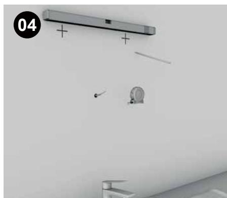
Los espejos iluminados se fijan a la pared mediante tornillos. Consultando los soportes fijados en la parte trasera del espejo, marque la posición de los orificios para los tornillos en la pared, verifique la horizontalidad de las marcas con un nivel de burbuja. También asegúrese (alineado con el centro del lavabo o pila) que el espejo esté centrado de acuerdo con la instalación.
