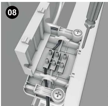
Conecte primero el cable del neutro (azul) y posteriormente la fase (rojo, negro o marrón). Cierre la caja de conexiones para que permanezca aislada y las conexiones protegidas. Nota: En la mayoría de los casos, la luz del espejo no tiene un conector a tierra, ya que se dice que tiene "doble aislamiento".
