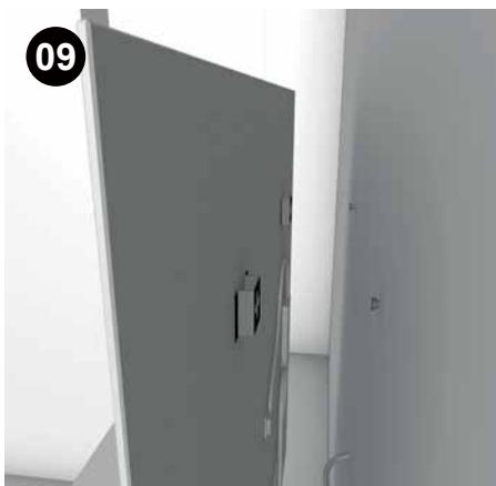
Verifique si la caja eléctrica está bien escondida, finalmente, si el cable de alimentación del espejo es demasiado largo, puede fijarlo a la pared con cinta adhesiva en un bucle ancho asegúrese también de que este cable no esté bajo tensión cuando el espejo esté sobre sus soportes.
