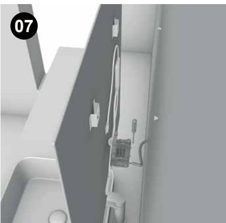
Abra la caja de conexiones entregada con el espejo, todos los conductores deben ser accesibles. Dependiendo del tipo de luz en su espejo, tendrá dos cables para conectar.
